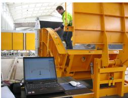
werden. Bei der Herstellung von Rotorblättern für Windenergieanlagen gilt es sowohl die Form zu vermessen, in der die Rotorblätter in einem Laminierprozess hergestellt werden, als auch die fertigen Rotorblätter selbst.
